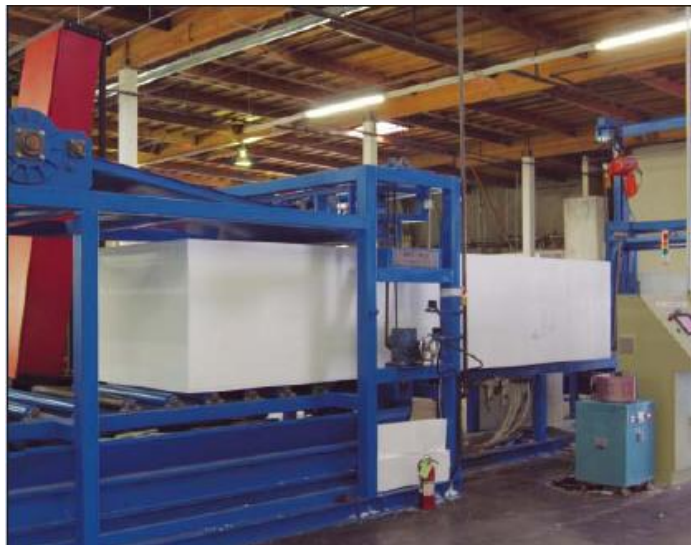
شکل ۱۰- فوم خارج شده از قالب بر روی تسمه نقاله
